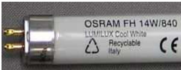
**Tubo fluorescente con una marca 840, que indica un IRC de 80 a 89 y una temperatura de color de 4000 K (Blanco natural).**
